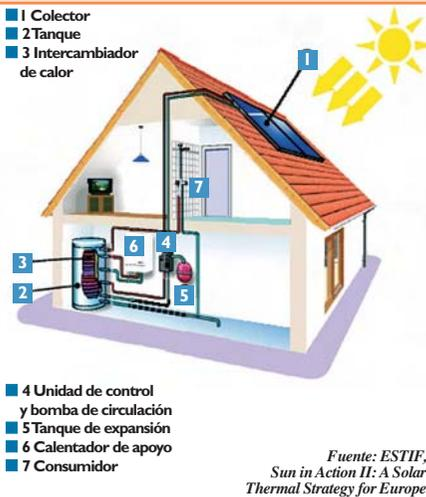
bida por una superficie que se calienta. Ésta, a su vez, emite radiación térmica (de onda larga), pero esta radiación es atrapada por el cristal, que impide su paso.
